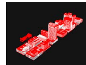
圧縮伝送した計測データに基づく倒壊箇所抽出例
