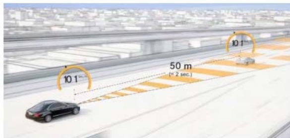
レーダによる車間距離測定(イメージ)
