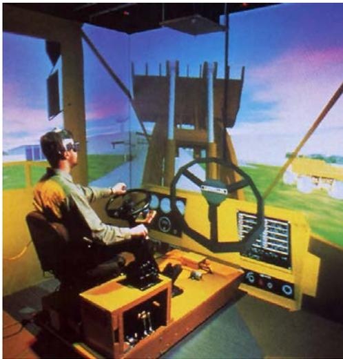
(出所)CAVEシステム(ブルドーザー運転シミュレータ)、キャタピラー社
