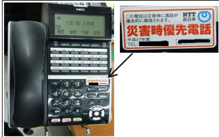
図表4 シールの貼付により災害時優先電話を識別している例
