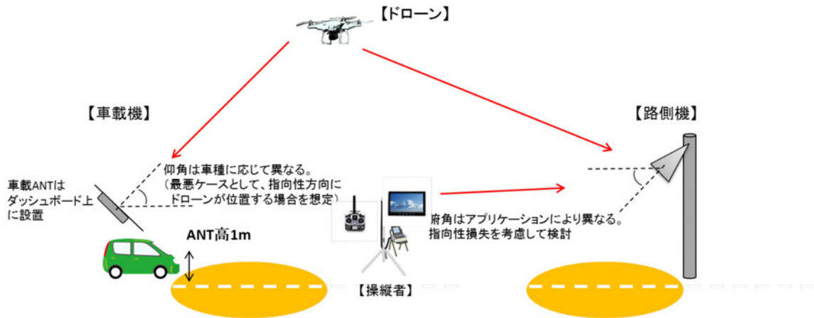
図参 4.2 狭域通信システムとの共用検討モデル
