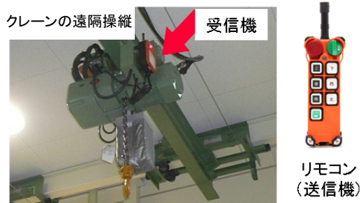
図 3-5 テレコントロールの利用例
