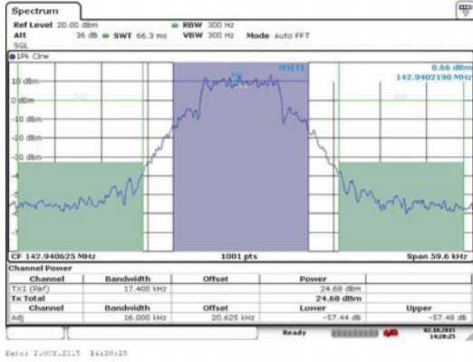
③ 3CH結束利用時の隣接システムへの漏洩電力
