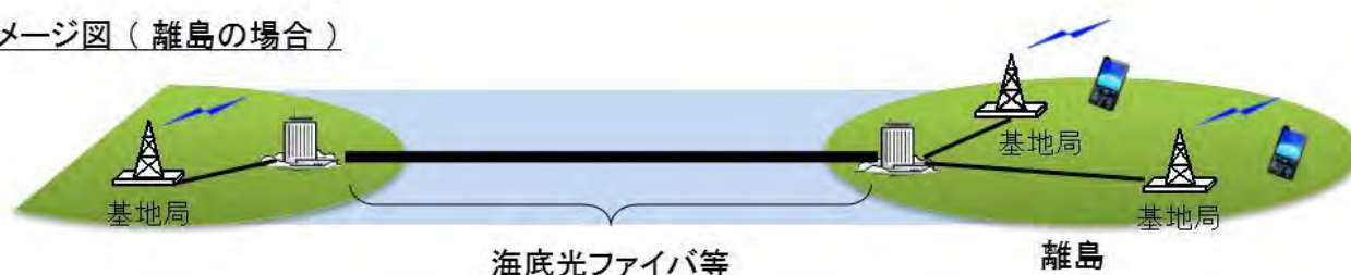
図3-1-15 離島等における高度移動通信システム構築のための光ファイバ網整備支援
