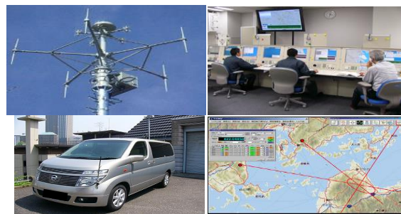
遠隔方位測定設備及び不法無線局探索車
