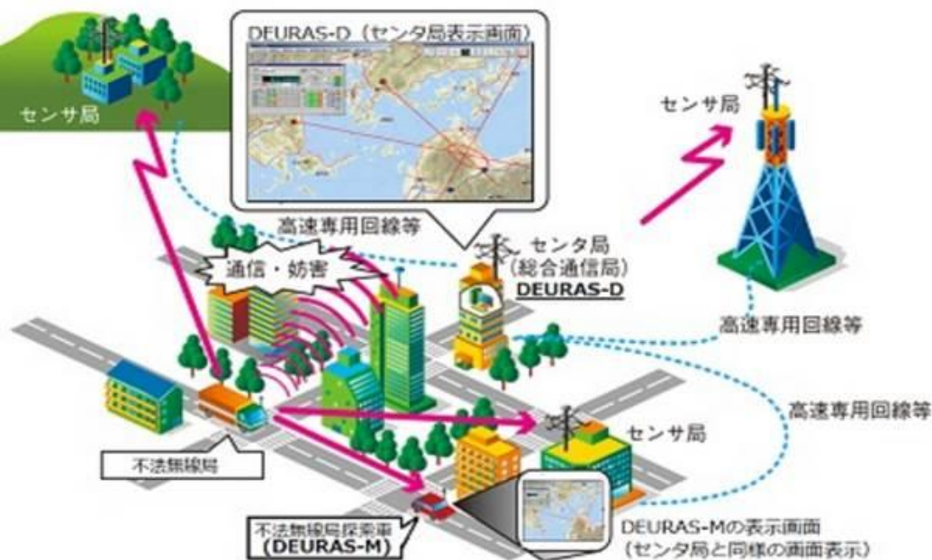
遠隔方位測定設備及び不法無線局探索車の概要
