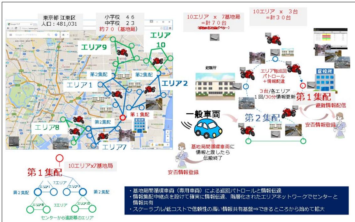
図 53 ネットワークの階層化による情報共有基盤のスケーラビリティ確保
