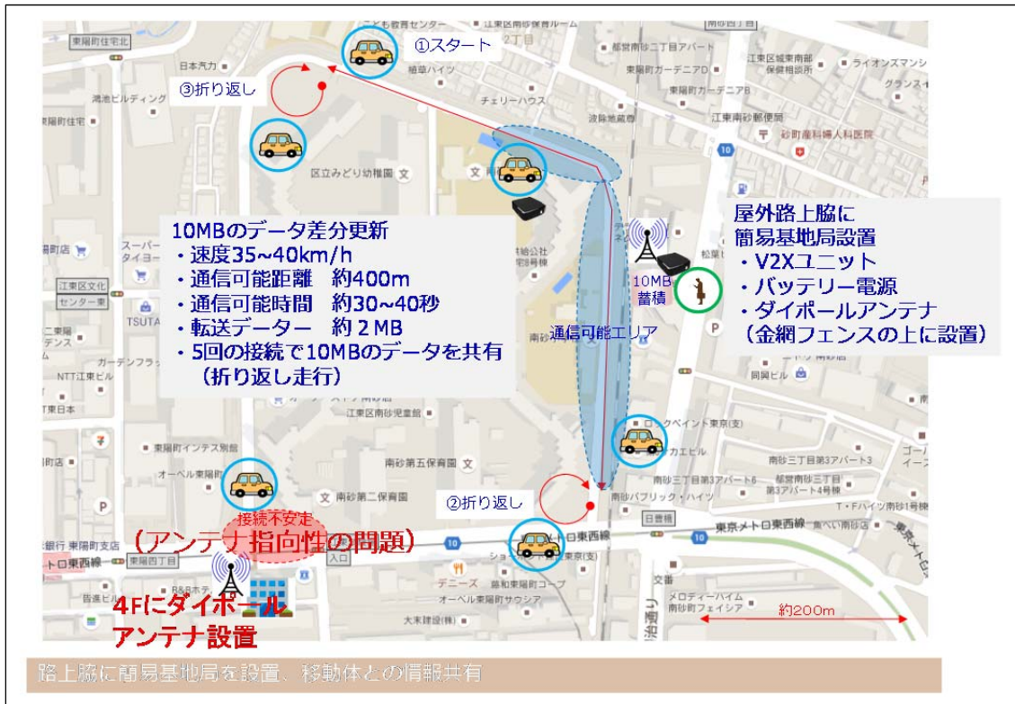
図 49 無線 LAN を活用した車載通信機の無線接続試験例①
