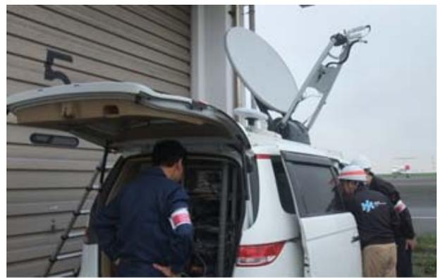
写真：車載型の通信端末の例
