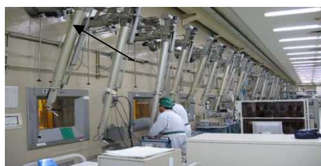
ガラス固化体評価試験を行っている様子
