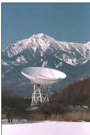
国立天文台野辺山宇宙電波観測所の45m電波望遠鏡。ミリ波帯で世界トップレベルの性能を持ち、数々の星間分子の発見や巨大ブラックホール発見などに貢献している。
