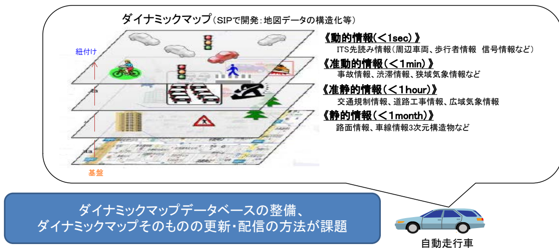
図2-3-21 ダイナミックマップの仕組み等
