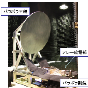
図：アレー給電反射鏡アンテナ試作品
