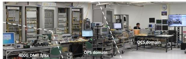
**STRAUSSテストベットの全体像：**400Gbps DMT方式光パケットスイッチング(OPS)ドメインおよび1Tbps 可変グリッド波長多重(Flexi-grid WDM)ドメインのデータプレーンは、NICT 耐災害ICT研究センター(仙台)に設置。JGN回線を用いて、制御プレーン(KDDI研、さいたま市)に接続した。また、日本の2ドメインおよび欧州3ドメインは、マルチドメイン・オーケストレーター(CTTC, スペイン)により一括制御した。
