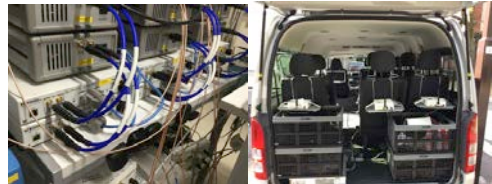
図4: (左) 無線装置と12.8GHz UP/DOWNコンバータ (右) 車両搭載状態の無線装置
