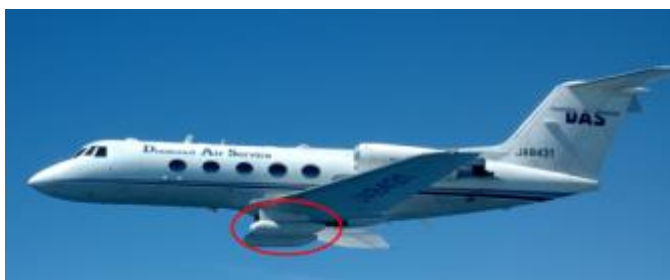
ガルフストリーム機に搭載された“Pi-SAR2” 両翼の付根に設置された2つのアンテナポッドに、 送受信用のアンテナが格納されている(赤線枠内)
