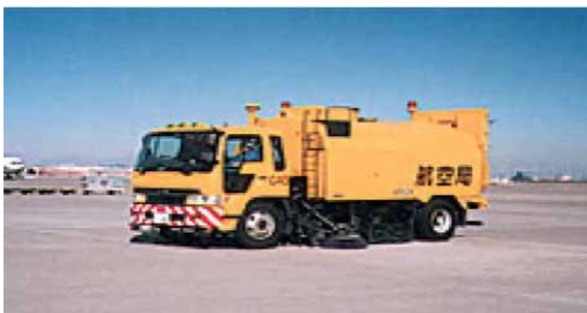
●舗装面清掃工: 航空機エンジンへの吸い込みを防止するために、路面の異物や土砂等を回収・処分している。 (施工回数: 滑走路等で4~6回/年、道路駐車場で8~48回/年)
