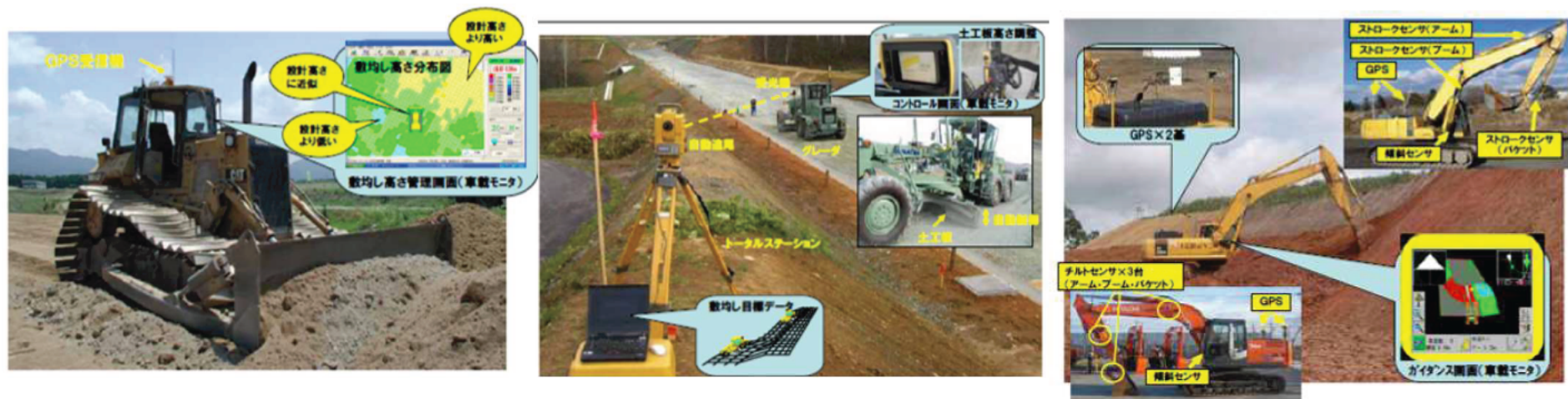
ブルドーザやグレーダ等のマシンコントロール（敷均し）
