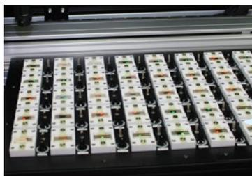
◀新開発のリン光有機ELデバイス(下)とデバイスの耐久試験の様子(左)。長時間発光させながら、ロボットアームに取り付けた計測器で輝度を計測する。
