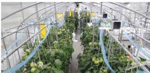
◀トマトの水耕栽培の実証実験の様子。枠の上にあるボックスがマルチセンサの無線センサノード。トマトの根元にも設置されており、周期的に環境データを計測している。
