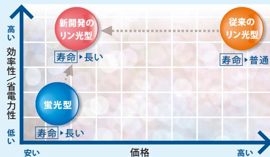
▲これまでの蛍光型、リン光型と新開発のリン光型の比較。高効率(省電力)で低コスト、長寿命を実現した。
