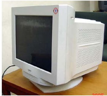
ブラウン管式ディスプレイ 15~35kHzの磁界が発生
