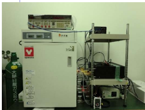
100 GHz波帯ばく露装置(既存設備) 37°C、5% CO 2 +95%飽和湿度空気
