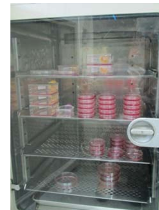
コントロール用通常インキュベータ (既存設備) 37°C、5% CO 2 +95%飽和湿度空気
