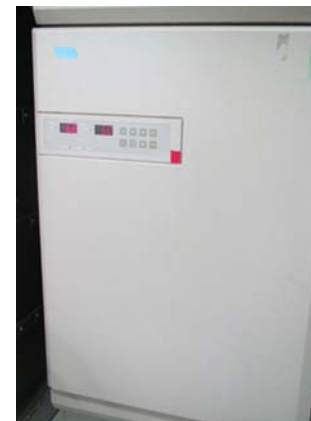
コントロール用通常インキュベータ (既存設備) 37°C、5% CO 2 +95%飽和湿度空気
