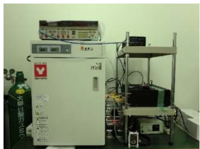
0.12THzばく露用インキュベータ(37°C、5% CO 2 、湿度100%)
