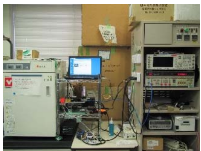
0.3THzばく露用インキュベータ(37°C、5% CO 2 、湿度100%)
