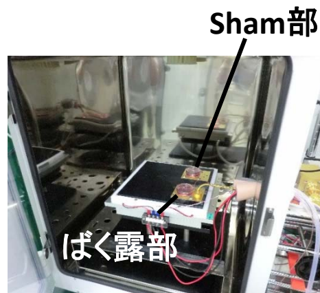
300 GHz波ばく露装置(既存設備) 37°C、5% CO 2 +95%飽和湿度空気
