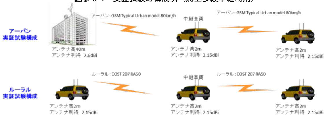
図参 9-2 実証試験の構成例（陸上多段中継利用）
