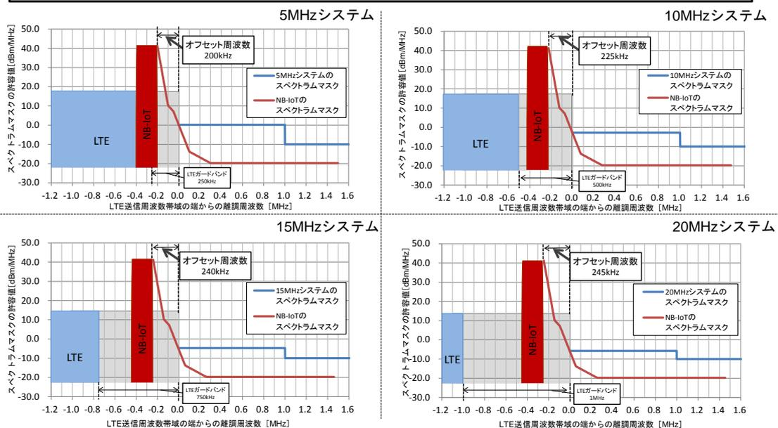
図2. 2-1 NB-IoT 移動局のスペクトラムマスク
