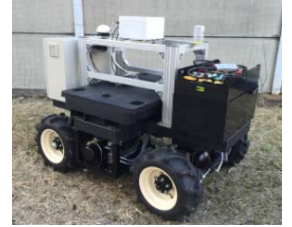
放水ロボット台車
