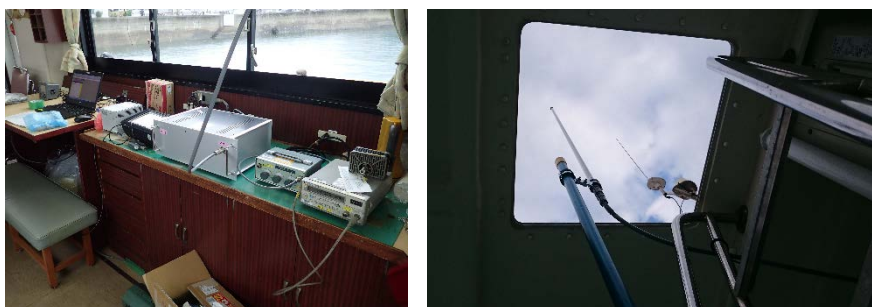
図 6.1-10 仮想船舶局の装置(左)及びアンテナ(右)
