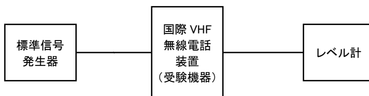
図 5.1-10 スケルチオープン測定検討のための試験系統図
