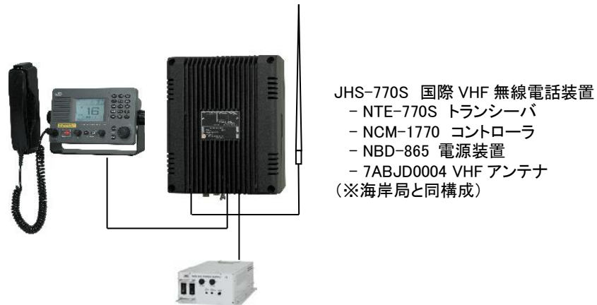
図 6.1-4 装置構成(仮想船舶局)
