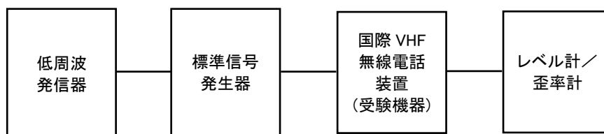
図 5.1-8 感度測定のための試験系統図
