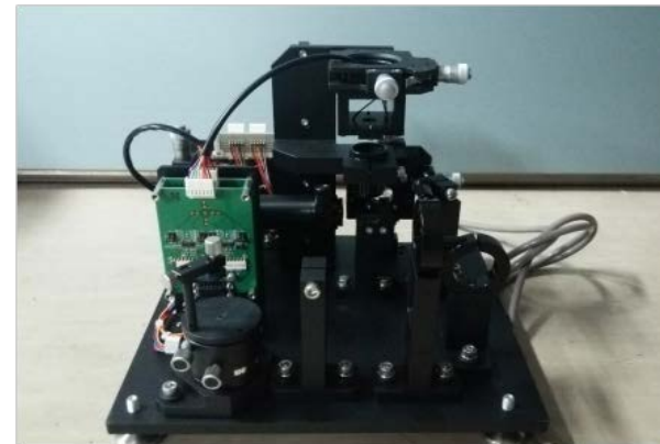
図1 アクティブ光空間通信装置
