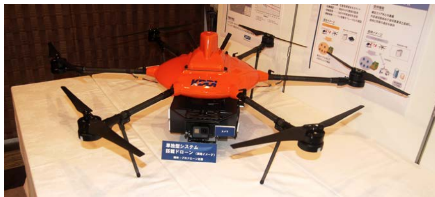
【携帯電話基地局を搭載したドローン】
