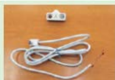
①市販の分配器(上)、コネクター、同軸ケーブルを用意する
