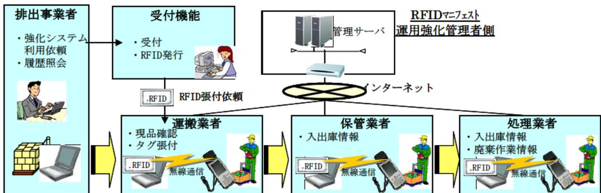
図 4.13 RFID マニフェスト運用強化方式イメージ
