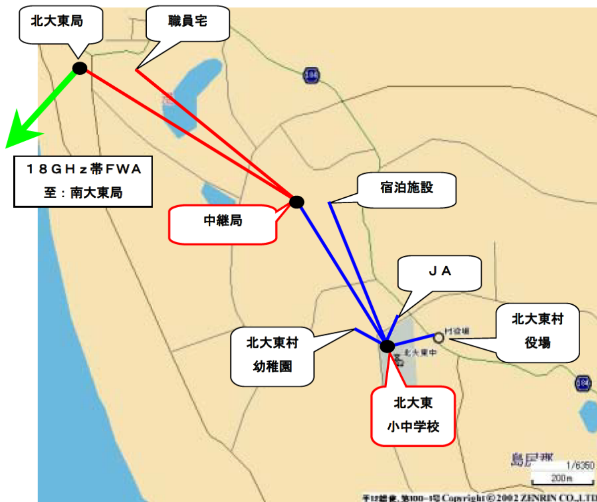
図 2.1.2 北大東村内 各施設配置構成 (5GHz帯FWA)
