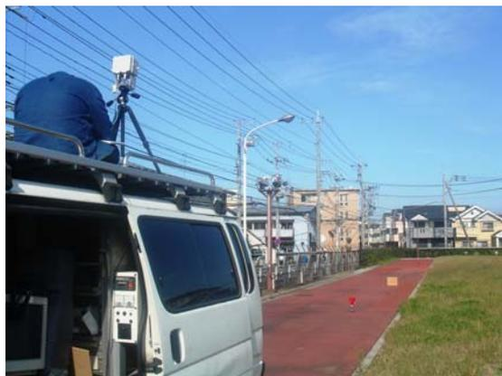
図 3-4 投棄物（ダンボール）の検知試験
