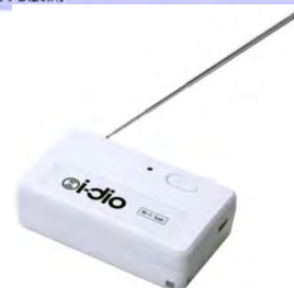
V-Low マルチメディア放送受信機 (写真提供: i-dio)
