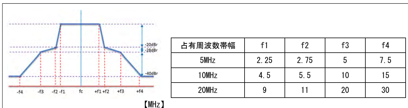
図 4.2.2.2-2 5.7GHz 帯無人移動体画像伝送システムの送信特性
