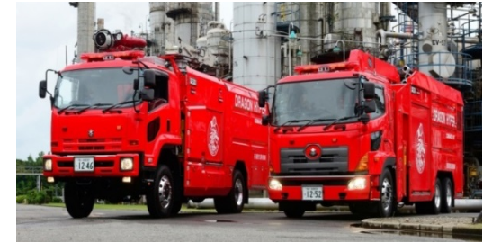
【エネルギー・産業基盤災害対応型消防水利システム】
