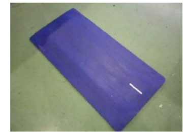
リーダライタのアンテナ (マット型)
