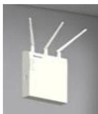
30人を超えるような学級で全員が一度にiPadを使えるようにするには、左の写真のような業務用の「無線LANアクセスポイント」を使わなければならない。アクセスポイントの機種によって違いはあるが、1機で30~60台の子機(iPad)が接続できる。機器の能力に余裕を持たせることを考えると、1つの教室にアクセスポイント1機ずつは必要になってくるかと思われる。
