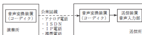
第7図 電話回線を利用して予備回線を構成する場合の例
