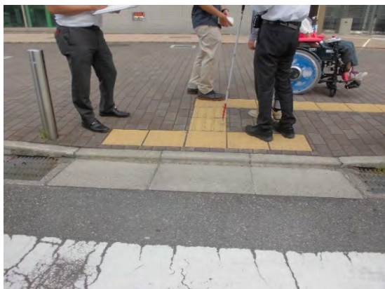
(注) 5 cmの段差を電動車椅子で乗り越えようとしたところ、段差との衝突で、車椅子の前輪が浮き上がった。
