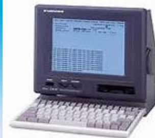
NBDP 遠距離伝送用で文字伝送のための無線設備。
