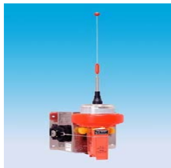
衛星EPIRB 船舶が遭難した場合に水圧センサーが働き浮上して自動的に遭難信号を発信する設備。
