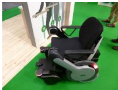
「WHILL NEXT」の 衝突防止機能で、人が集まる 場所でも安心して移動が可能
