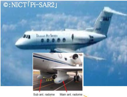
※1 合成開口レーダー（SAR: Synthetic Aperture Radar）:地上に向けて電波を放射し、その反射波を受信側の合成開口の信号処理技術を用いて対象物を高い分解能で取得可能なレーダー。
