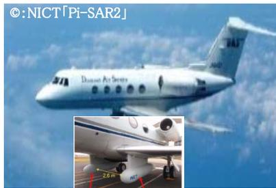
※<sup>1</sup> 合成開口レーダー（SAR:Synthetic Aperture Radar）：地上に向けて電波を発射し、その反射波を受信側の合成開口の信号処理技術を用いて対象物を高い分解能で取得可能なレーダー。
