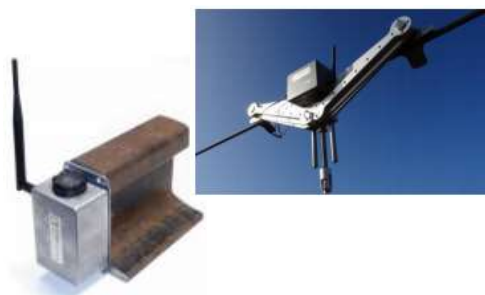
線路温度、ケーブル張力
