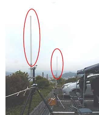
左:ガイダンス局のアンテナ 右:規正局のアンテナ
