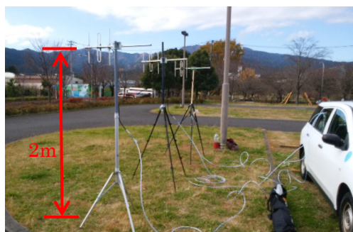
(b)八木アンテナ設置状況（山岳・関東）
