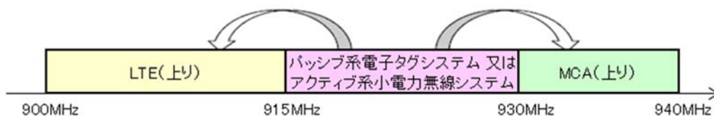
図 3 - 2 920MHz 帯電子タグシステム等の干渉検討の組み合わせ
