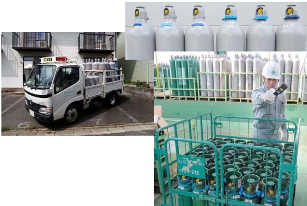
図 2 - 2 ガスボンベのトラック輸送及びガスボンベの電子タグ読み取りの例
