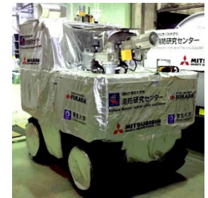
【放水砲ロボット（一次試作）】
