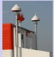
電離圏監視装置
