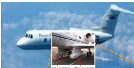
※ 合成開口レーダー（SAR: Synthetic Aperture Radar）システム：航空機にアンテナを搭載し移動することで航空機の進行方向に仮想の大きなアンテナを合成し分解能を高めたレーダーシステム。
